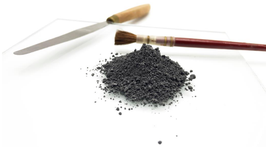
Fig. 2. Grisalla negra. Con frecuencia, las grisallas contienen en torno a un 15% y un 20% de plomo, en forma de polvo que hay que moler antes de mezclarlo con diluyentes y aplicarlo. En este proceso, el polvo puede ponerse en suspensión y ser respirado. Créditos: Jonatan Díaz
